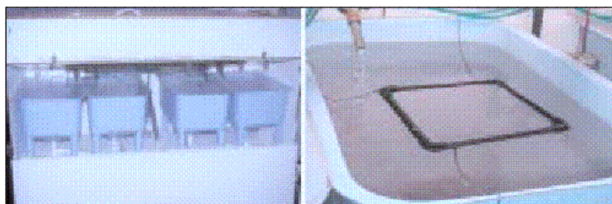
Figura 15. Fotografías del interior de una cámara mostrando (a) los cuatro tanques y (b) el flotador donde se situaba el alimento encapsulado.
